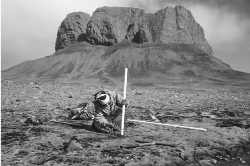
Foto 1. Construcción de Piezómetros en la Cuenca del Arroyo Matías, Isla 25 de Mayo (King George) similares a los realizados en la Isla Marambio (Seymour).
