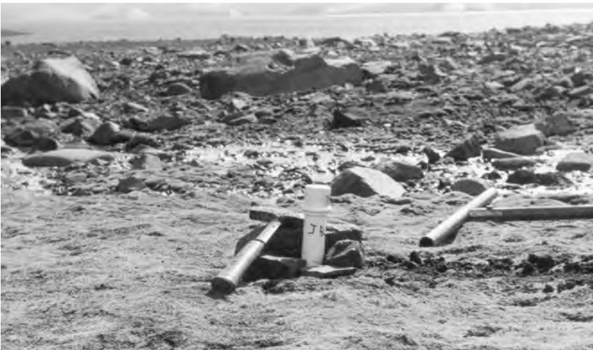
Foto 2. Piezómetro Tipo construidos en las cuencas de estudio
