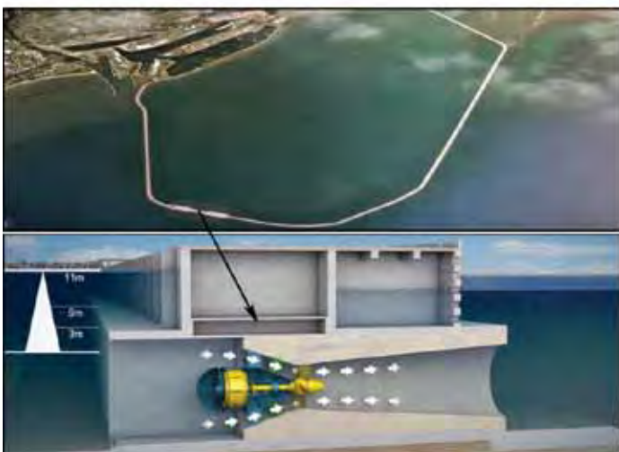
2313. Energía desde el océano. Diferentes máquinas se han diseñado (arriba) para convertir la fuerza de las olas o corrientes de agua en energía eléctrica. Se busca convertir el movimiento del agua mediante muelles mecánicos o aire comprimido que se usa para mover una turbina y un generador. Todos los implementos están en fase de prueba en instalaciones de mayor o menor escala. La energía mareomotriz (abajo-izquierda) consiste en cerrar un área (laguna de marea) mediante un muro de escollera construido por el dragado del lecho del mar con una cobertura de rocas. Las mareas diarias se aprovechan en ambos sentidos mediante turbinas hidráulicas. En todos los casos el impacto ambiental se mide en términos de efectos sobre la vida marina, sobre la recreación (playas) y la pesca comercial. La energía azul (derecha), en fase experimental, consiste en poner en contacto el agua salada con la dulce, separadas por una membrana semipermeable. La diferencia de presión osmótica se utiliza para generar electricidad.
