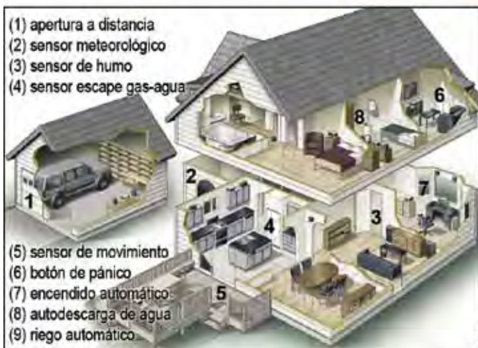
4124. Construcción eficiente y sustentable. La eficiencia busca reducir el consumo de energía en todas las etapas de las viviendas (arriba-derecha): materiales de construcción, ahorro en iluminación y climatización, equipos certificados, etc. La certificación (LEED) entrega una oblea con grados de calidad a aquellas construcciones que aplican conceptos de arquitectura sustentable. En la figura se muestra el local Nike en Unicenter (derecha). La domótica (abajo-izquierda) vuelve más eficiente a los hogares gracias al uso de la automatización que utiliza sensores distribuidos y un software centralizado. El biomimetismo es una forma de pensar el diseño industrial, la arquitectura y las ciudades. El estudio clásico aprende sobre el árbol, pero el biomimetismo hace un estudio de cómo funciona la naturaleza para que el diseño industrial y la construcción adopten esas estructuras (derecha).
